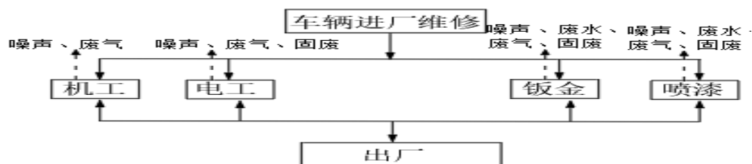
图 5-2 项目工艺流程及产污节点图
