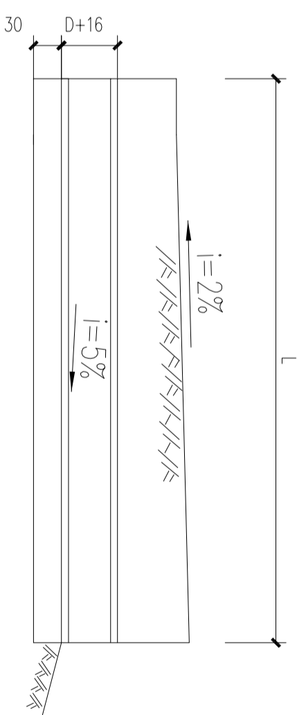
成品混凝土涵管剖面图 1:25
